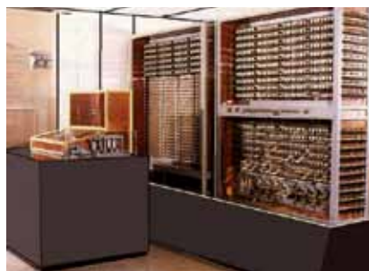
Abb. 38: Z3 – erste vollautomatische, programmgesteuerte und frei programmierte, in binärer Gleitpunktrechnung arbeitende Rechanlage; ein Nachbau steht im Deutschen Museum in München
