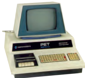
Abb. 59+60: Der PET 2001 war der erste PC bzw. Heimcomputer des Unternehmens Commodore. Zusammen mit dem Apple II (links abgebildet: Apple II+) des Unternehmens Apple Computer war er einer der ersten in Serie als Fertiggerät gebauten Microcomputer überhaupt.
