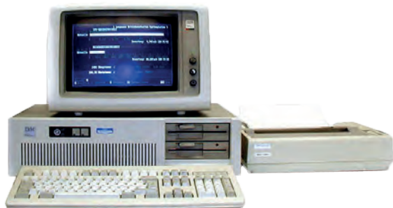
Abb. 63: Der IBM Personal Computer AT ist die dritte Generation von IBM-PCs. Er war der Nachfolger des IBM PC XT und IBM PC und wurde 1984 mit integrierter Festplatte und 6-MHz-CPU der Öffentlichkeit vorgestellt. Im Unterschied zu seinen beiden Vorgängerserien verwendete IBM erstmals die 80286-Architektur von Intel und PC DOS 3.0 – das eigens für den AT entwickelt worden war.
