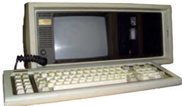
Abb. 61: Der COMPAQ Portable PLUS: Ausgeliefert ab Oktober 1983 als Nachfolger des Compaq Portable PC, des ersten IBM-kompatiblen Personal Computers. Compaq investierte eine Million Dollar in den Nachbau des IBM PC BIOS (Reverse Engineering) und startete so das Zeitalter der IBMkompatiblen Computers.
