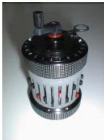
CURTA (1948), Mechanische Handrechenmaschine, anwendbar für alle vier Grundrechenarten
