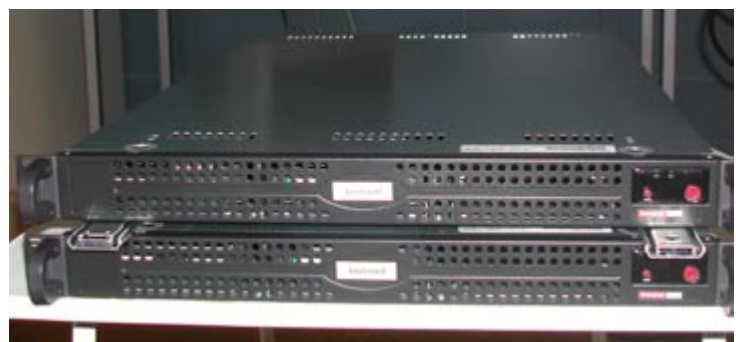
Unter „echten“ Laborbedingungen: Die beiden Frontendknoten des neuen HPC-Clusters wurden bereits vorab geliefert und am RRZE getestet.
