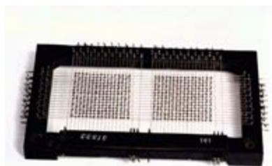
Schnellspeicher aus der Z22/Z23: Magnetkernspeichermatrix mit 512 Bit
