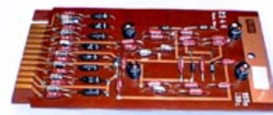
Schaltkreise aus der Z23: Transistorsteckkarte
