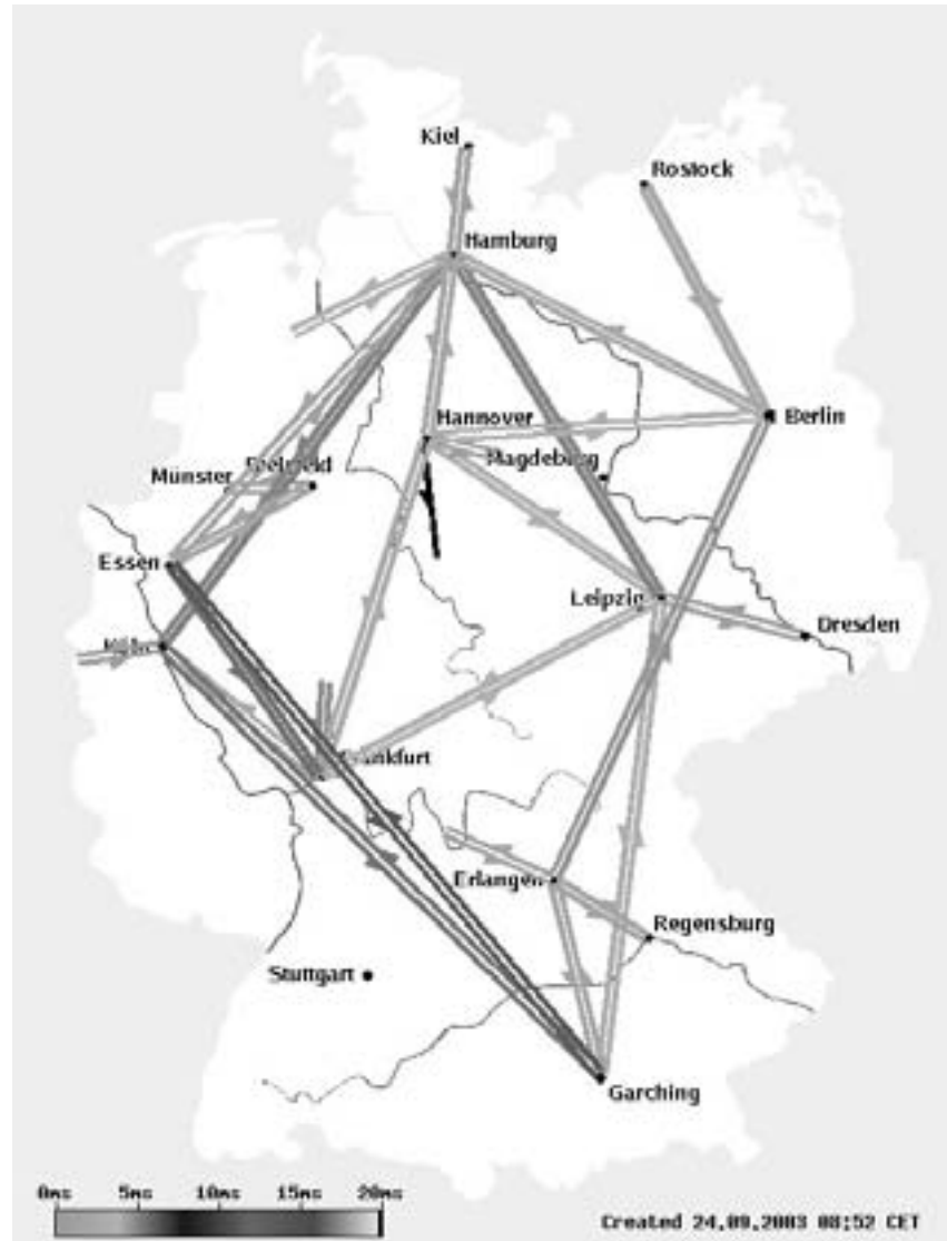
Abb. 2: Derzeitiger Ausbaustand und momentane Delaywerte (in Millisekunden, farblich kodiert, Max. < 10 ms) zwischen Level 1 und Level 2-Standorten im G-WiN [4]. Die Level 2-Standorte (Regensburg, Kiel, ...) sind nur mit einem Level 1-Standort verbunden.
