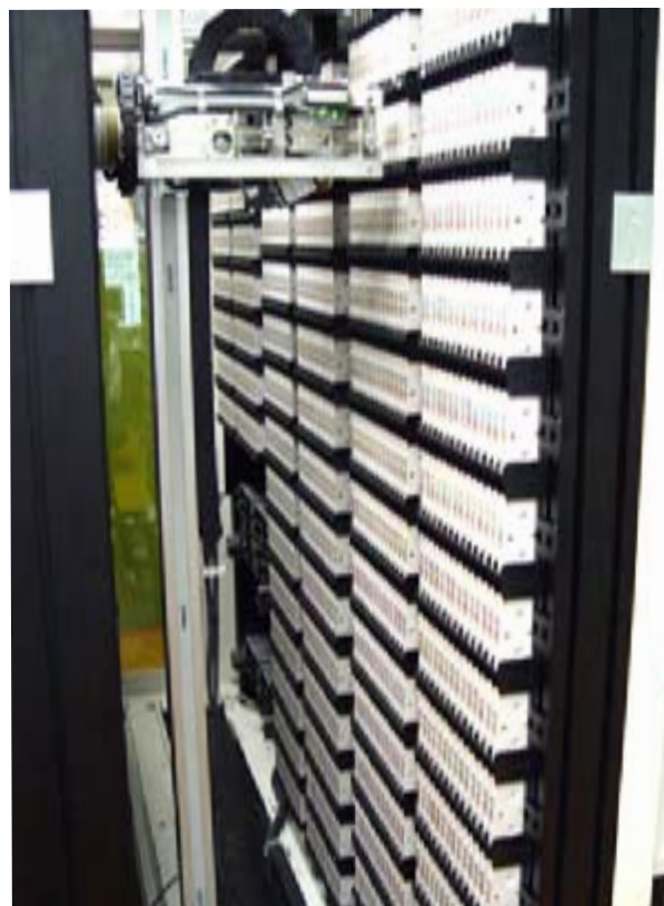
Der Greifarm des Roboters entnimmt dem Bandlager eine Kassette, um sie in ein Laufwerk zu laden.
