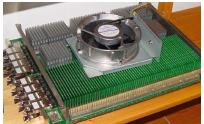
Ein Prozessor (!) der VPP300 inklusive 2GB Speicher und einem Lüfter.
