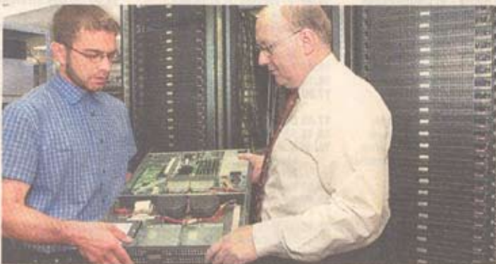
Gerhard Hergenröder (rechts) und Gerhard Wellein vom Erlanger Rechenzentrum zeigen eines der 73 einzelnen Module mit jeweils zwei Intel-Prozessoren.
