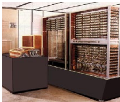
Erste vollautomatische, programmgesteuerte und frei programmierte, in binärer Gleitpunkt-rechnung arbeitende Rechenanlage: Z3, 1941; ein Nachbau steht im Deutschen Museum in München
