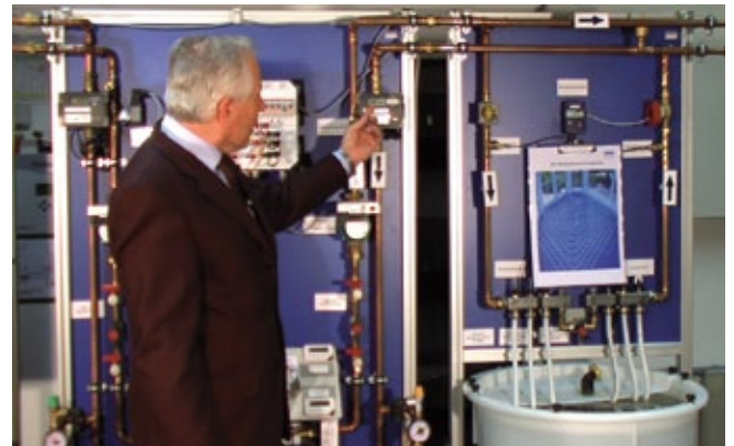
Akademie für Lehrerfortbildung: Wilhelm Kichensteiner erläutert Aufbau und Funktion einer Wärmepumpe
