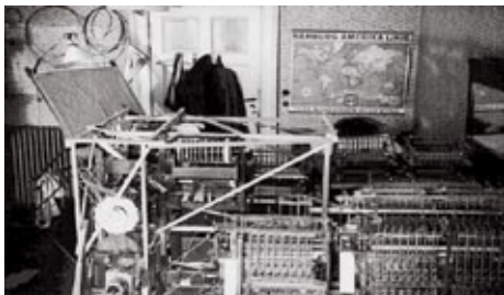
Konrad Zuse baute seinen ersten Versuchsrechner, die Z1, von 1936 bis 1938 in seiner Wohnung in Berlin
