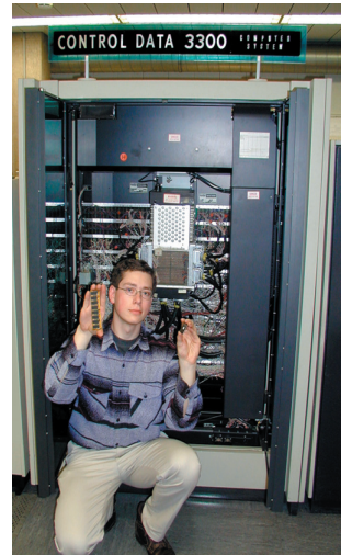
Abb. 11: Größenvergleich eines Kernspeicherschranks von 1968 mit 48 kBytes und dem Hauptspeicher eines PC mit 64 MBytes von 1998
