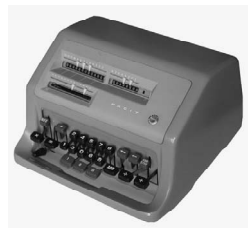
Abb. 15: FACIT CA1-13 (Sprossenradprinzip, ca. 1960)
