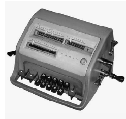
Abb. 13: FACIT C1-13 (Sprossenradprinzip, 1957)
