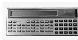
Abb. 11: erster in Basic programmierbarer Taschenrechner Sharp PC1212 von 1983
