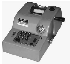
Abb. 14: Saldiermaschine Olivetti Summa Quanta 20R (Zahnstangenprinzip, ca. 1966)
