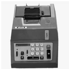
Abb. 14: Saldiermaschine Olivetti Summa Quanta 20R (Zahnstangenprinzip, ca. 1966)
