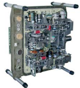
Abb. 18: Elektromechanischer Analogrechner – Lenkanlage der Pershing-1.
