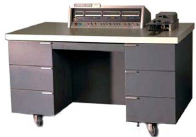
Abb. 15: Tischrechner Control Data 160-A; der Tisch ist der Rechner.
