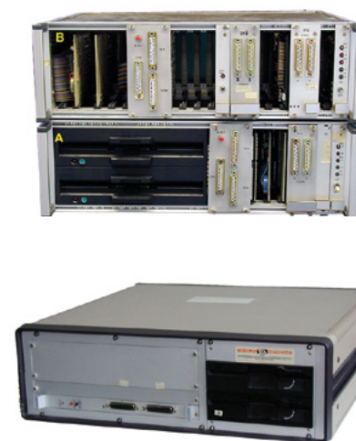
Abb. 25 Inhouse-Entwicklung von RJE-Stationen auf Basis eines Zilog Z80-Rechners bzw. eines Motorola 68000-Rechners
